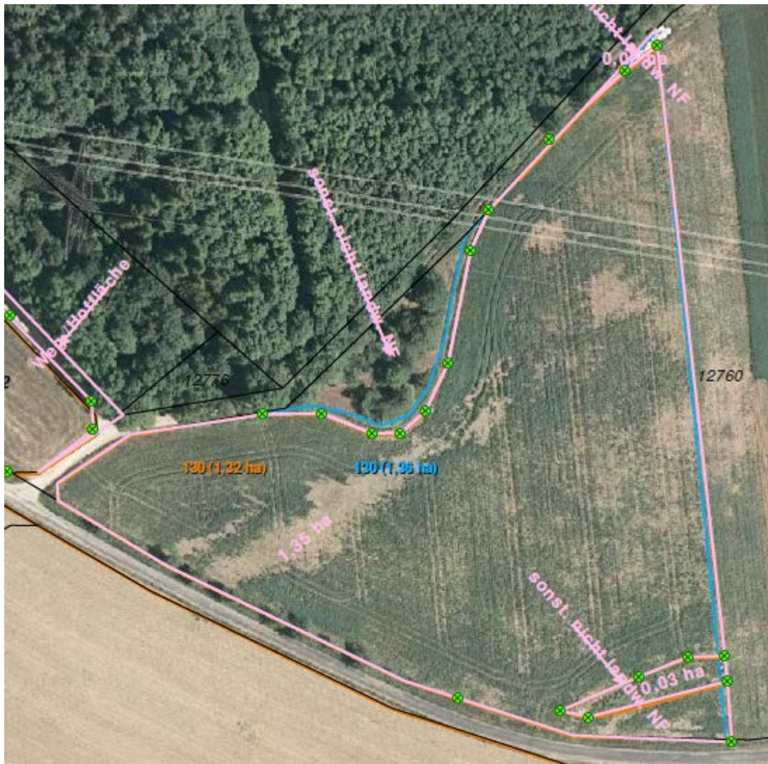
Abbildung: Befliegungsergebnis mit eingezeichneten Ergebnissen der Feldvermessung
